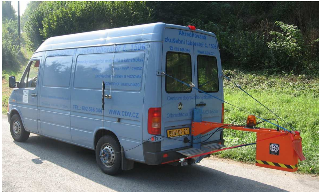
Obr. 2: Sestava georadaru pro měření za provozních rychlostí s jednou horní anténou
