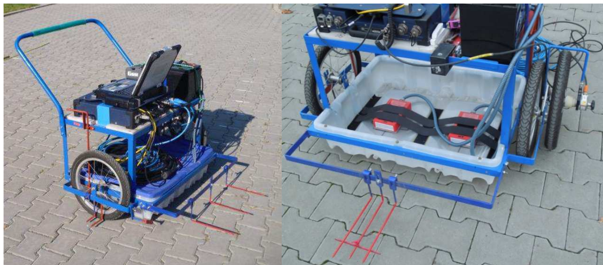
Obr. 2: Mobilní zařízení pro měření polohy kluzných trnů a kotev se dvěma anténami 1,6 GHz a polohovacím zařízením
