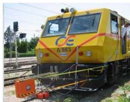
Obr. 3 Príklady ROADSCANNERS rôznych GPR nastavení pri meraní na železničných tratiach.
