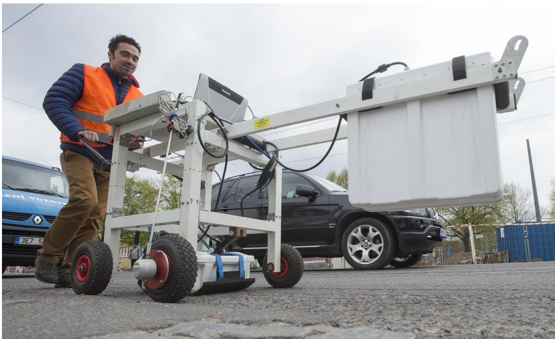
Obr. 2: Sestava georadaru pro měření s air-coupled i s ground-coupled anténou
