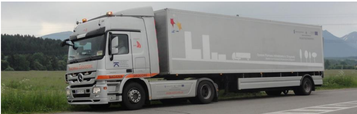
Obr. 1: Traffic Speed Deflectometer, vlastník IBDiM (Polsko), foto: archiv CDV
