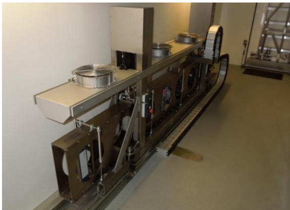
Obr. 4: Tuhý nosník s Doppler-laser snímači uvnitř návěsu zařízení TSD, foto: archiv CDV
