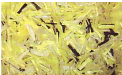
Obr. 1 Směs aramidových a polyolefinových vláken určených pro asfaltové směsi vyráběné za horka
