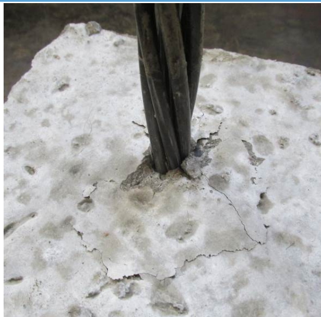
Obr. 4 Vzorek z betonu C45/55 po zkoušce
