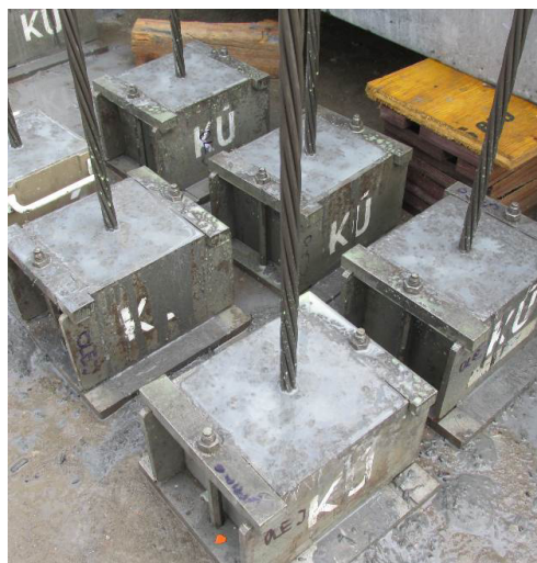
Obr. 2 Vybetonované vzorky z UHPC
