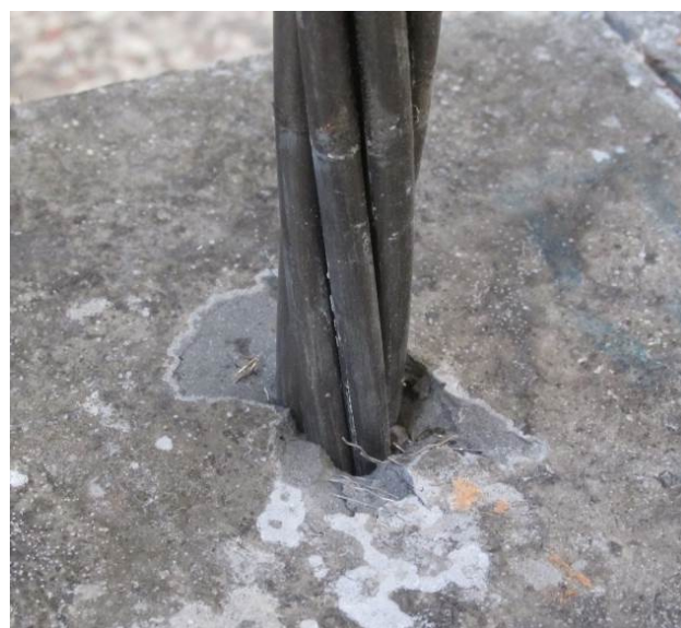
Obr. 5 Vzorek z UHPC po zkoušce
