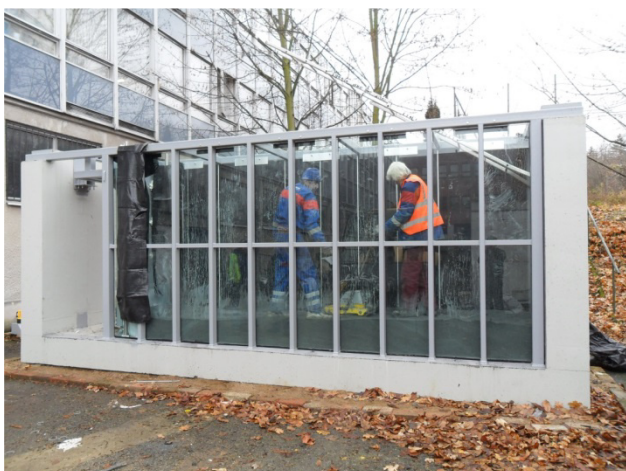
Obr. 1 Plnění zkušebního zařízení hutněným pískem
