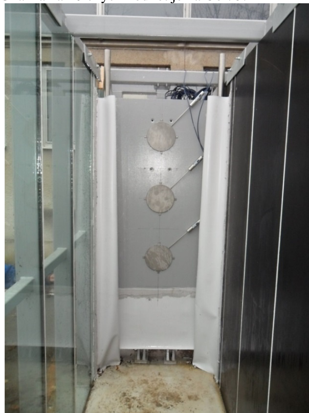
Obr. 2 Pohled na pohyblivou čelní stěnu se snímači zemního tlaku
