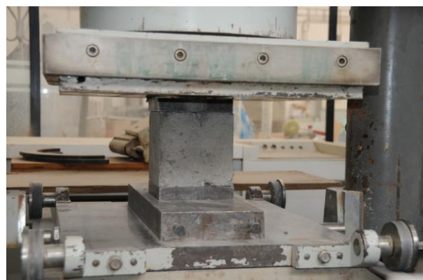
Obr. 1 Tlaková zkouška prováděná na krychli 150/150/150 mm
