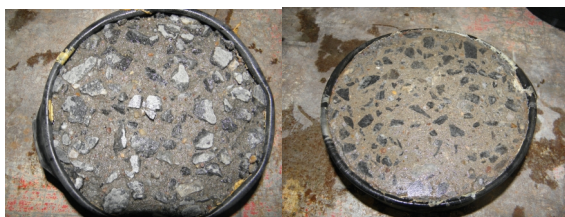
Obr. 2 Velmi porušená směs CH 6 po 150 cyklech vlevo, neporušená směs CH 1 po 150 cyklech vpravo.
