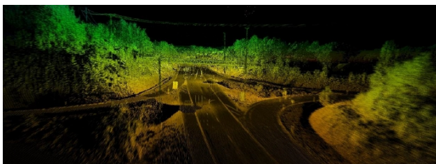
Obr. 2 3D mračna bodů s detaily silnice v okolí [1].
