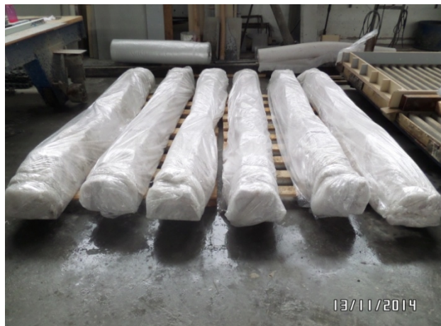
Obr. 2 Pražce uložené ve vlhkém prostředí ke zrání.
