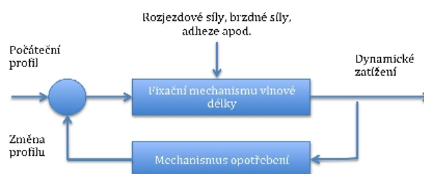
Obr. 1 Obecný mechanismus rozvoje periodických vlnovitých vad pojezdové plochy kolejnice
