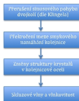
Obr. 2 Fixační mechanismus rozvoje skluzových vln a vlnovitosti
