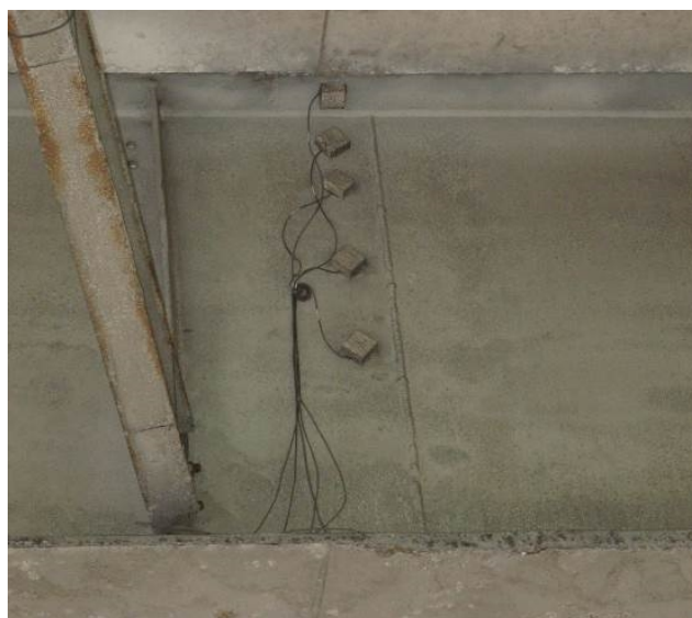
Obr. 2 Pohled na snímače teploty instalované na vnitřním hlavním nosníku – stav v listopadu 2014.
