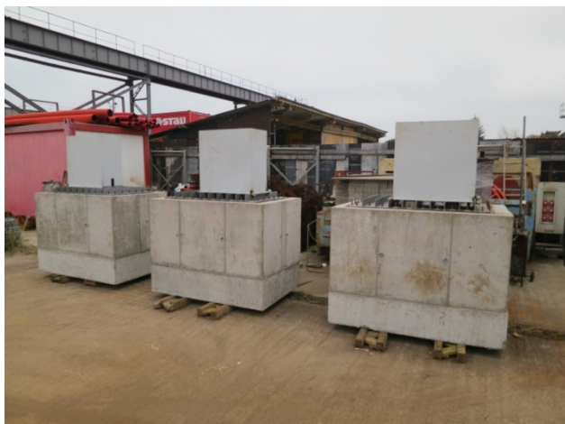
Obr. 1 Zkušební nádrže pro ověření funkce těsnění spár.
