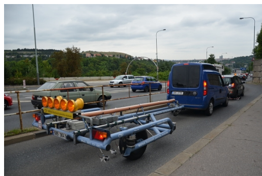
Obr. 2 Měřicí CPX zařízení CDV.
