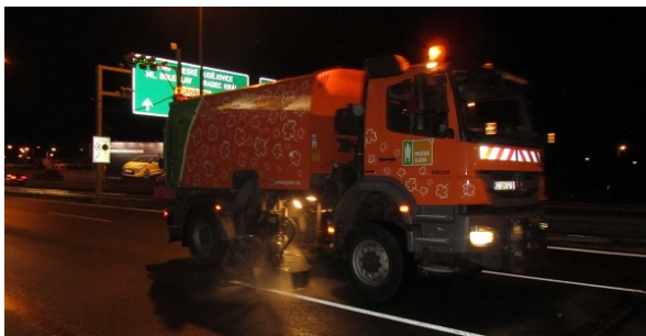
Obr. 3 Čistící vozidlo Pražských služeb při čistění nízkohlučného povrchu Viaphone®.
