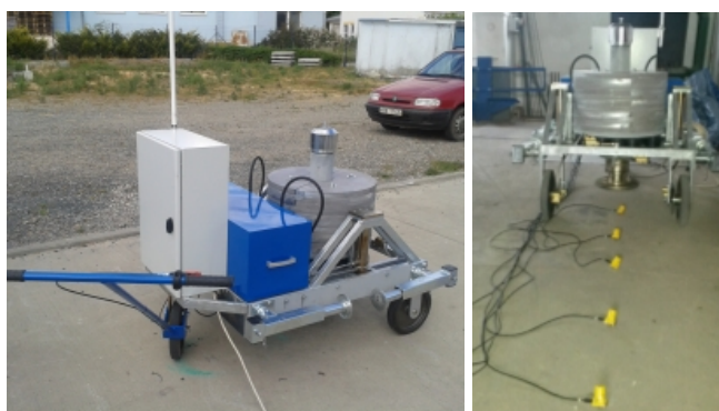
Obr. 5 HWD-S Heavy Weight Deflectometer Stationary (vlevo), rozmístění geofonů (vpravo).
