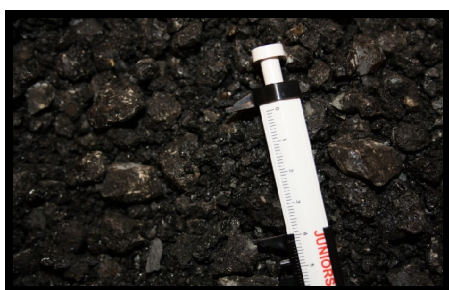
Obr. 1 Opětovně předczený asfaltový materiál.
