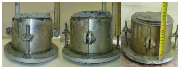
Obr. 2 Popílkové stabilizáty po ukončení sledování – fluidní popílek ETI / fluidní ložový popel ELE / úletový popílek EME po 28 dnech zrání bez aditiv.
