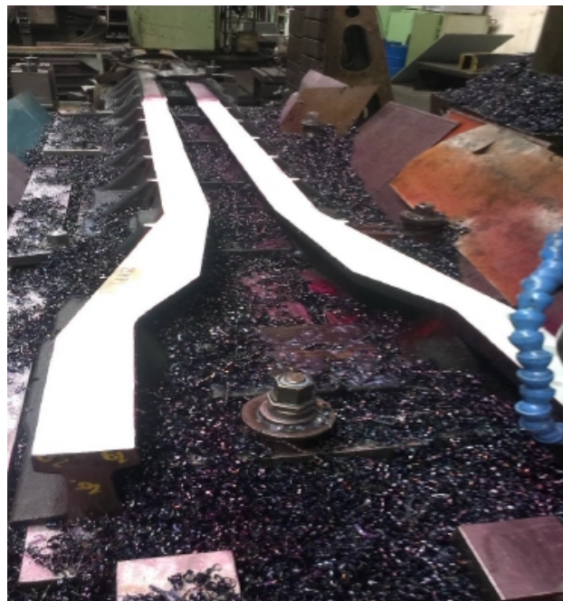
Obr. 1 Plátkování rámu srdcovky s PHS.
