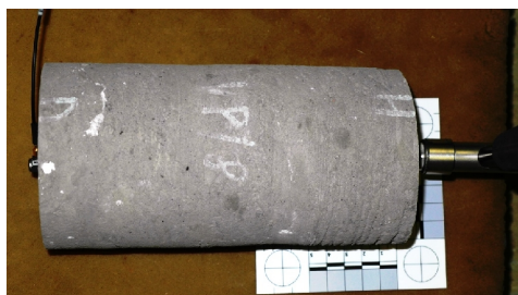
Obr.1 Stanovení dynamického modulu pružnosti rezonanční metodou.
