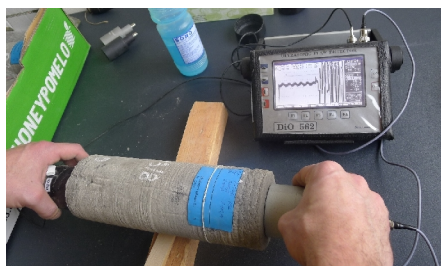
Obr. 2 Stanovení dynamického modulu pružnosti pomocí ultrazvuku.
