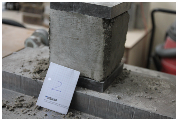
Obr. 2 Vzorek stříkaného betonu – tunel Sudoměřice.
