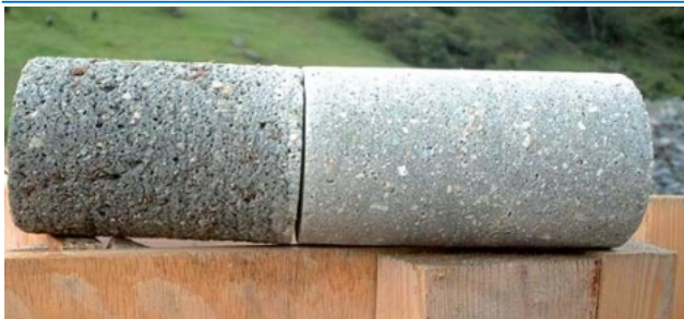
Obr. 2 Vliv způsobu nástřiku na kvalitu ostění (betony zhotoveny ze stejné betonové směsi za stejných podmínek různými operátory trysky [4]).
