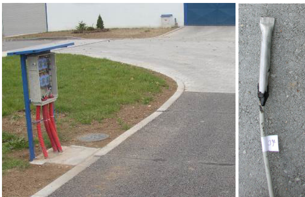
Obr. 3 Umístění teplotních snímačů na pokusném úseku v Tišnově – 4 výškové úrovně, kontinuální záznam.
