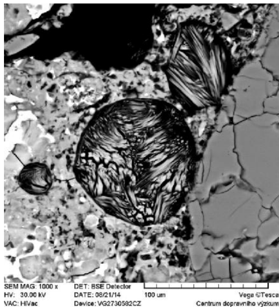
Obr. 4 Póry vyplněné jehlicemi etringitu.
