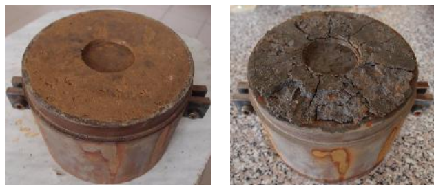
Obr. 2 Zkušební vzorky F6 CI a F6 CI+25%EDE po zkoušce IBI.
