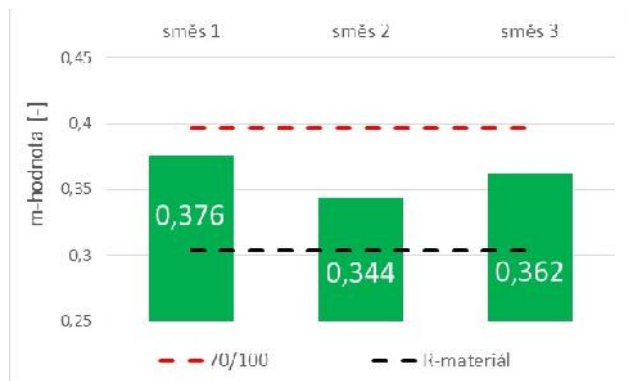
Obr. 2 Výsledky m-hodnoty m_{60p} při teplotě -16\text{ °C} .
