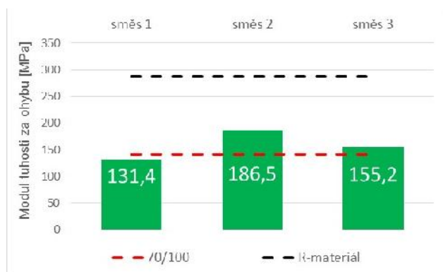
Obr. 1 Hodnoty modulu tuhosti za ohybu S_{60p} při teplotě -16\text{ °C} .
