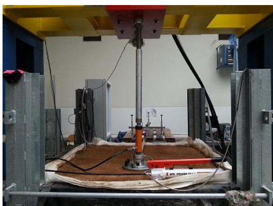
Obr. 1 Zkušební stand – statická zatřívací zkouška.
