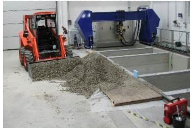
Obr. 3 Úspřádání pokusu pro sledování prostupu vody konstrukcí v laboratorním geotechnickém zkušebním poli (schéma, foto).
