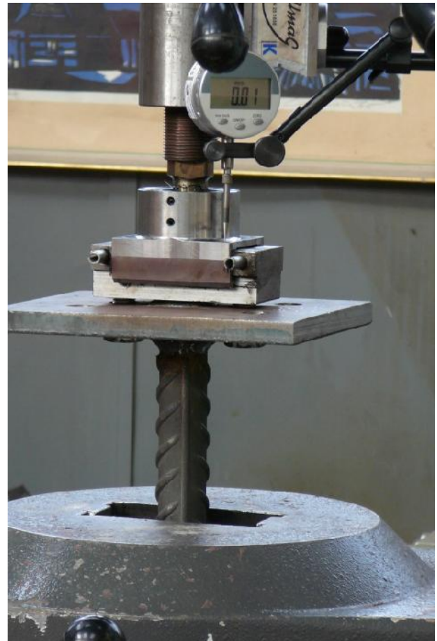
Obr. 1 Statická zkouška vzorku stěžejky.
