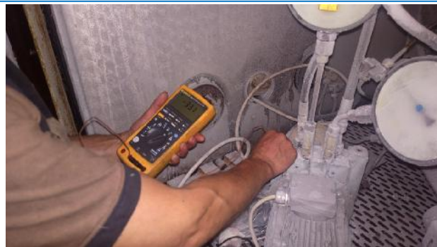
Obr. 2 Měření teploty oleje na konci zkoušky v mrazicí komoře.
