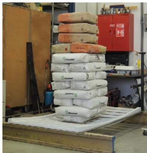
Obr. 3 Panel při statické zkoušce 500 kg.
