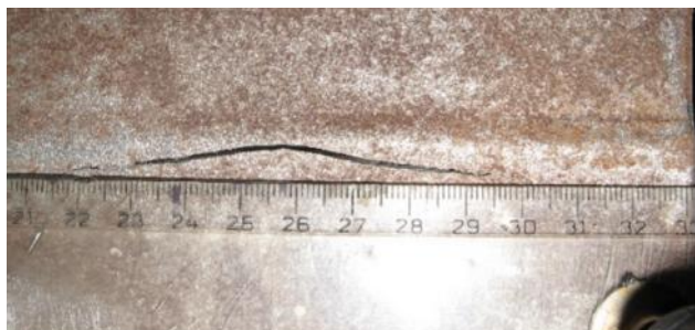
Obr. 2 Délka trhliny na spodní stran ě pásnice nosníku p í ukon ění experimentu.
