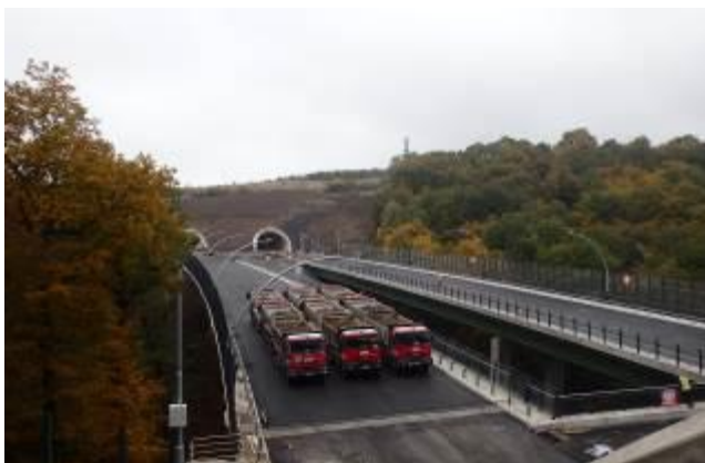
Obr. 5 Průběh zatřívací zkoušky – sestava Pole 1L.
