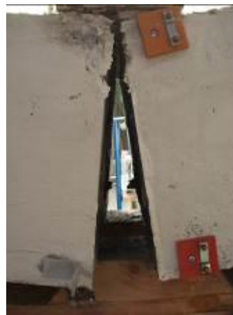
Obr. 2 Laboratorní test v prostém ohybu.
