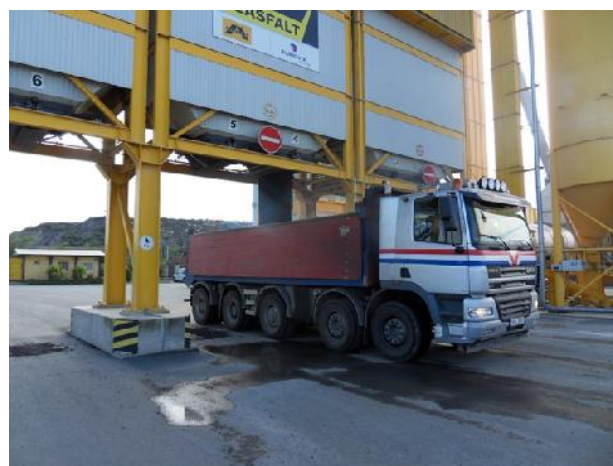
Obr. 1 P tinařprávné vozidlo používané pro p epravu asfaltové směsi p ed vážením náprav.
