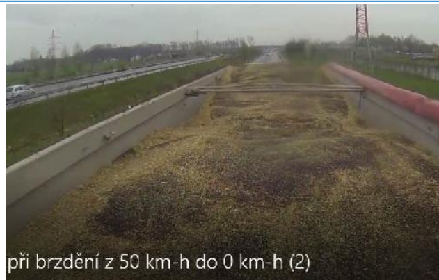
Obr. 2 Záznam z kamery instalované na návěsí při odkryté plachtě – vizuální doklad o pohybu nákladu – epky.
