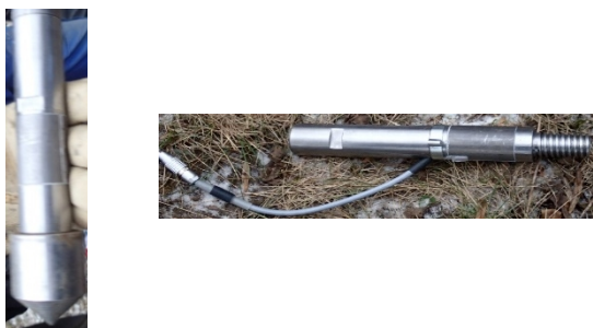
Obr. 1 První a poslední díl penetra ního souty í (díly instrumentované odporovými tenzometry)
