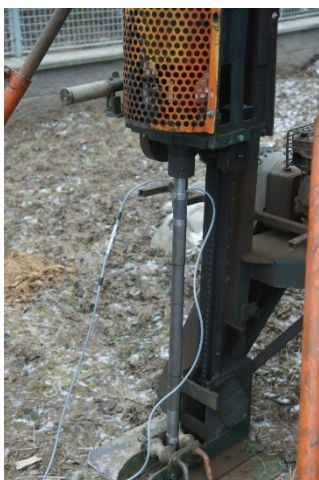
Obr. 2 Instrumentované penetra ní souty í p í pr b hu zkoušky
