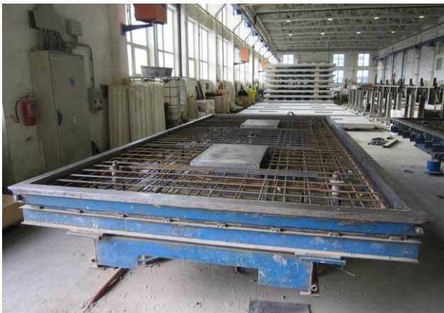
Obr. 1 Formy pro výrobu panelů pevné jízdní dráhy OBB-PORR
