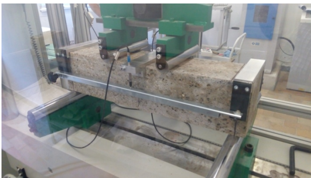
Obr. 4 Zkouška trávce 4 bodovým ohybem
