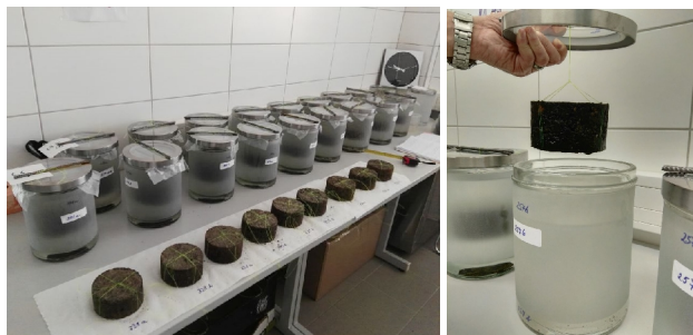
Obr. 1 Vyluhovací zkoušky monolitických vzorků
