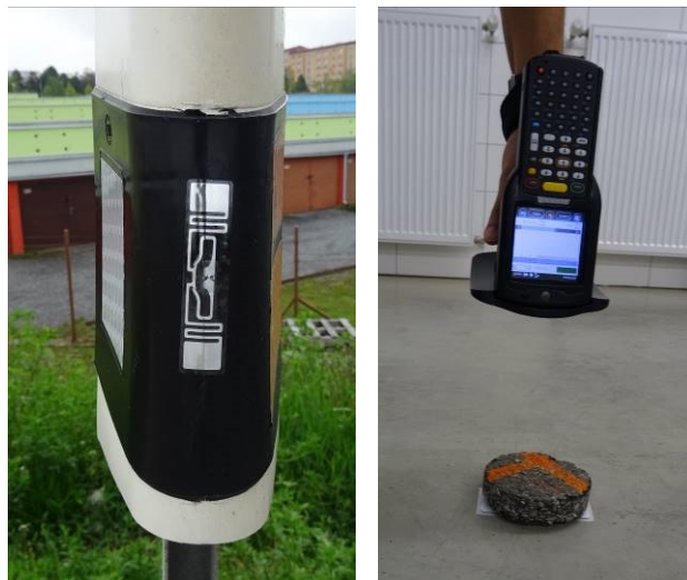
Obr. 2 Vlevo: RFID tag na smířové sloupce, vpravo: zkouška schopnosti získat informace z RFID tagu pod asfaltovou vrstvou
