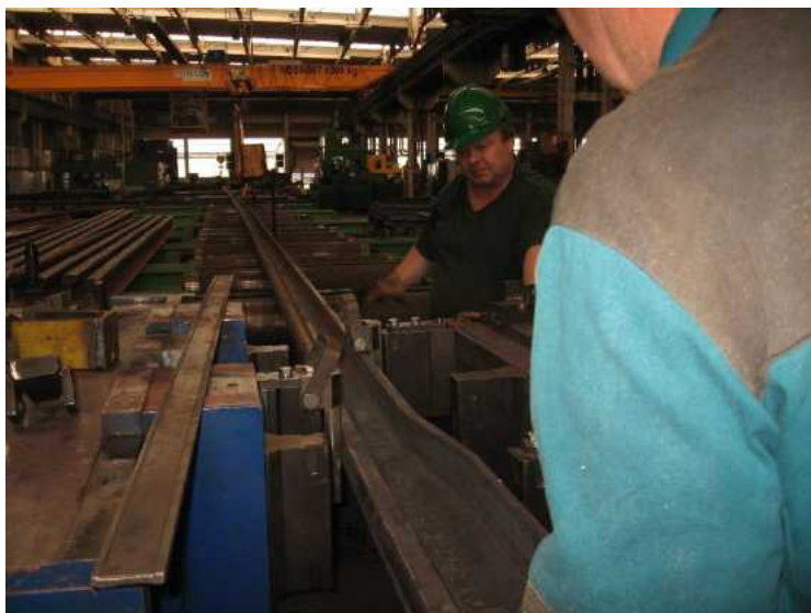
Rovnění jazyka před obráběním
