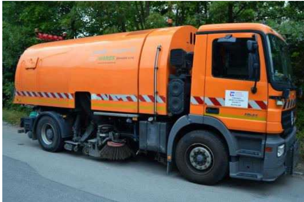
Specializovaný čistící vůz SR (čištění vysokotlakým proudem vody)
